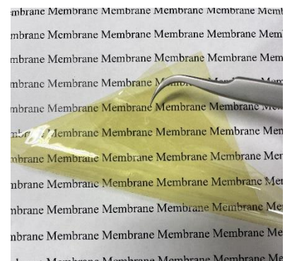
図1：本研究で開発したアニオン膜QTAFの構造と写真。ベンゼン環を主骨格とする構造に少量のフッ素系置換基を組み合わせた構造が、イオン導電率と安定性の両立を可能にする。
